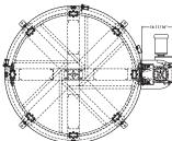
MINIMUM CONVEYOR DISTANCE IS 45° ON EITHER SIDE OF TURNTABLE DRIVE; TURNTABLE IS CAPABLE OF 45° INTERVALS POSITION #1 IS EXTREME CLOCKWISE
